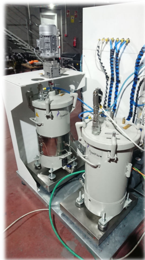
TANQUE DE ACERO DE 30 LITROS CON AGITADOR ELECTRONICO Y SISTEMA DE CALENTAMIENTO
